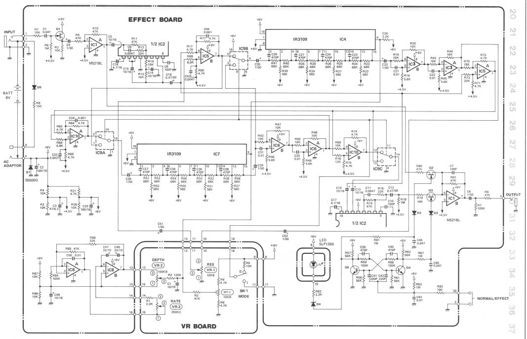
IC2 . . . . . . NE571 IC3, 5, 6, 8, 10 . . . IR9022 IC9 . . . . . . . . HD14053 Q1, 2, 3. . . . . . . 2SK30A-Y Q4, 5. . . . . . . . 2SC945-P  CT. 1984
